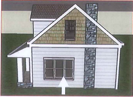
Sous-sol apparent traité à l'identique du reste de la façade
